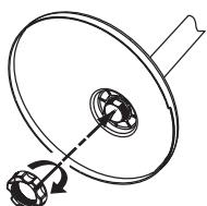
將中柱和底座的卡位對準，再用底座螺栓來固定。
