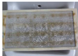
③將清潔劑(中性)均勻噴在 模組正反面，並放置5分鐘
