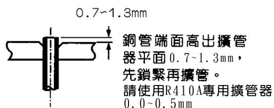
表面光滑，圓周高度相同 若擴管偏斜或破裂，異物嵌上，須以切管刀切斷，重新擴管。
