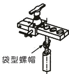
擴管前須先將銅管毛邊削除，用活動扳手取下二方閥或三方閥上之袋型螺帽，放入銅管以進行擴管工作。
